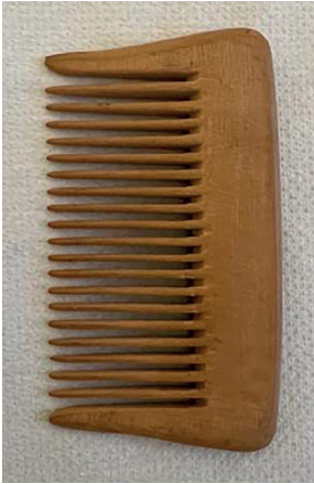
Abb. 11: Kamm, gebraucht als reflektierender Polarisator. Die Polarisationsachse liegt senkrecht zu den Kammzähnen.
